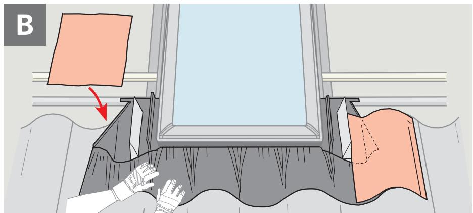
**ENGLISH:** For installations with cut corner tiles, apply self-adhesive flashing material when necessary (not supplied by VELUX).**ESPAÑOL:** En el caso de instalaciones con tejas recortadas de las esquinas, aplique material de tapajuntas autoadhesivo cuando sea necesario (no suministrado por VELUX).**FRANÇAIS :** En cas de tuiles coupées dans le coin, utiliser du solin autocollant, lorsque nécessaire (non fourni par VELUX).
